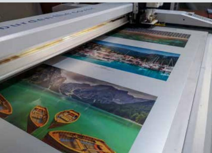
Технология цифрового анодирования (субанодной печати) DigitELOX® подобна процессу татуировки, когда краску помещают не на поверхность металла, а внутрь его.
